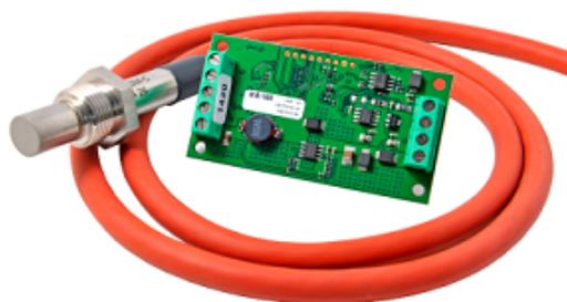
上海高传高温氧化锆氧气传感器O2S-FR-T2特性：非消耗性的氧化锆传感元件氧压范围2mbar...3bar高稳定性和精度，可测量0... \*\*氧对于其他气体无交叉干扰无需温度稳定内置加热元件允许气温温度-100~400 $^{\circ}\text{C}$  O2S-FR-T2-18C/B/A是氧化锆氧气传感器，敏感元件是氧化锆，采用两个氧化锆盘，在其中间是一个密封空间。其中一个盘起的功能是可逆氧气泵，依次充满样品气和抽空此小空间。另一个盘用于测量氧分压差比率，得到相对应的传感电压。氧化锆盘作为氧气泵运行时，需要的700 $^{\circ}\text{C}$ 的温度由加热元件产生(配套的电路板O2I-FLEX-092可以提供加热和线性模拟量输出功能。)。氧气泵使小空间范围内达到额定的小值和大值压力所花的时间和环境中氧分压值具有对应关系。河南顶空分析仪用氧气传感器厂家报价上海高传尾气检测用氧传感器。
